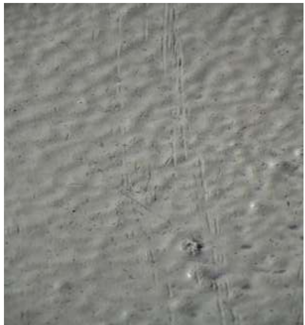
Figur 2.32 Polyurea Micorea HS med vidhäftningsförlust och gropar efter drygt 3 år på parkeringsdäcket i Baggen
